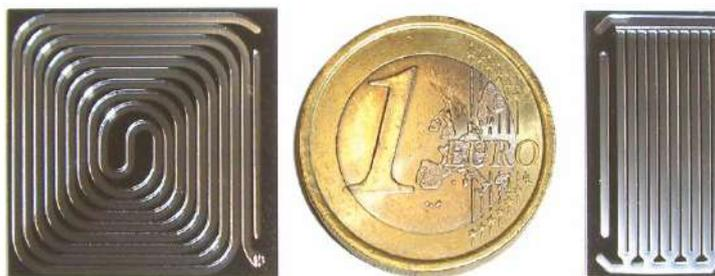
Figura 1 - Pre-concentratore e Colonna gas cromatografica MEMS
