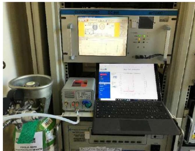
Figura 2 - Installazione in cabina del PyxisGC BTEX
