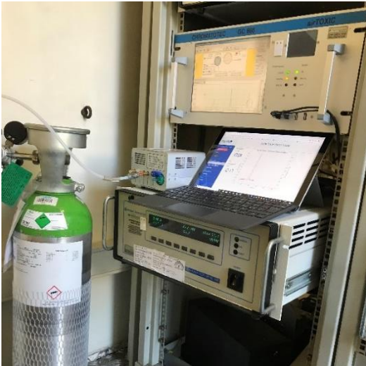
Figura 2 - Installazione in cabina del PyxisGC BTEX
