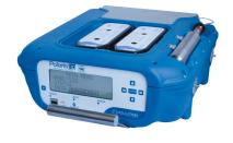
Pollution, con Polaris FID, ha realizzato un strumento "smart" completamente portatile che incorpora al suo interno tutto ciò che è necessario per le analisi (batterie, accumulatore di idrogeno, pompa e filtro ai carboni attivi per l'aria comburente e bombolette di gas di calibrazione e di aria tecnica per uno zero estremamente accurato), agevole anche per effettuare screening ambientali.
